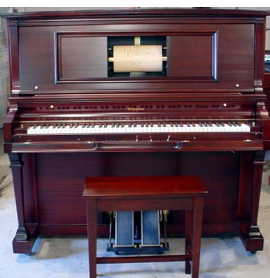
Abbildung 1: Player Piano mit eingespannter Klavierrolle: Unten die Antriebspedale zur Beschleunigung/Verlangsamung des Spieltempos.
