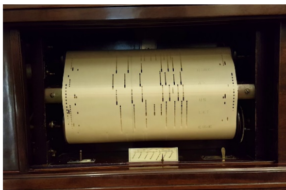
Abbildung 2: Klavierrolle mit digitalem Lochcode, der von einem pneumatischen Mechanismus im Inneren des Player Pianos ausgelesen wird und die Tasten automatisiert herunterdrückt.
