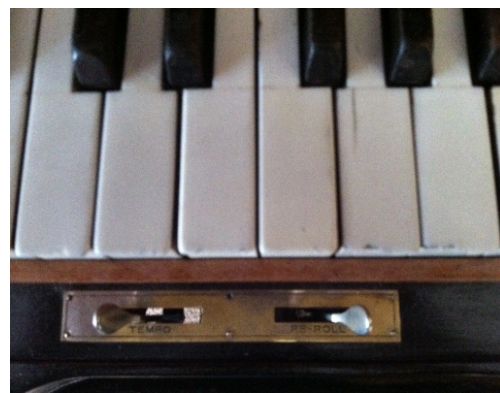
Abbildung 3: Das Interface des Player Pianos: Hebel zur Beschleunigung/Verlangsamung des Spieltempos.
